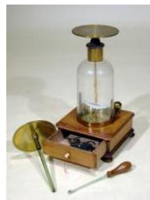
I corpi possono essere elettrizzati strofinandone la superficie, o – nel caso dei conduttori – mediante contatto con un corpo già carico. A questo scopo, intorno al 1775 Volta ideò l'**elettroforo** (nell'immagine, un campione in dotazione al Liceo Scientifico "Alessandro Serpieri" di Rimini).
