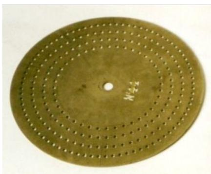
Il suono viene prodotto soffiando un getto d’aria perpendicolare al piano del disco posto in rapida rotazione. L’aria passa attraverso due fori successivi in un intervallo di tempo, il cui reciproco è la frequenza della vibrazione prodotta. Il campione in oggetto reca quattro serie di fori; la frequenza maggiore è quella generata dalla serie esterna.
