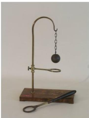
Si riscalda la sfera di metallo ponendola su una fiamma; ciò ne provoca la dilatazione. La sfera, che fredda poteva passare attraverso l'anello, non può più attraversarlo quando è calda.
