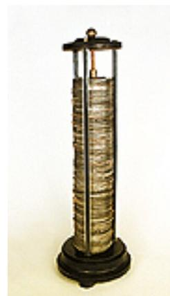
Ogni elemento è in grado di generare una forza elettromotrice di 0,76 V, quindi la tensione totale fornita in generale è data dal numero degli elementi per 0,76 V.
