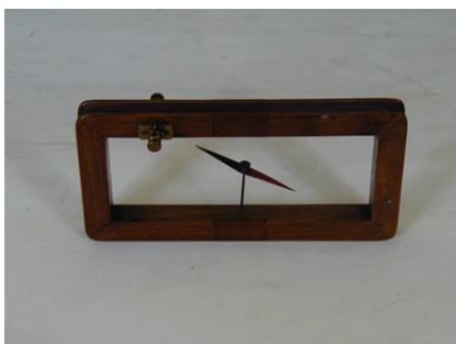
Le spire, avvolte lungo il perimetro del telaio e tutte percorse dalla stessa corrente nello stesso verso, generano nello spazio da loro limitato un campo magnetico di intensità uguale alla somma delle intensità dei campi prodotti dalle singole spire e capace di orientare lungo la propria direzione l'ago magnetico posto nel centro.
