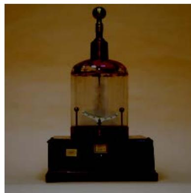
Una variante è l'**elettrometro condensatore** ideato dal Volta; a lato, un campione in dotazione al Liceo Classico "L. Ariosto" di Ferrara, di epoca imprecisata ma anteriore al 1875.
