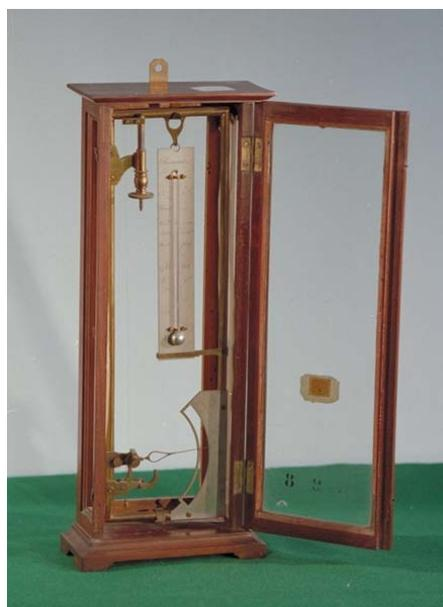
Nell'armadietto in legno, con porticina di vetro, è alloggiato anche un termometro. Un meccanismo a leva-indice azionato dalla deformazione del capello permette di leggere l'umidità relativa su un indice.
