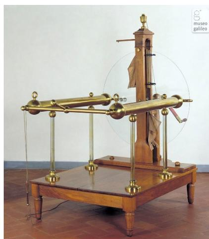
Tutte le macchine elettrostatiche convertono energia meccanica in energia elettrica. Nel caso della macchina di Ramsden il lavoro esterno consiste nel far girare manualmente mediante una manovella
